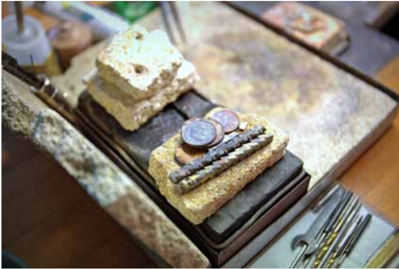
Münzen und Werkstücke aus der Lehrzeit von Mitra Hadjebi dienen als Unterstützung, etwa zum Aufbocken, beim Löteten Fotos: Rüdiger Sinn
