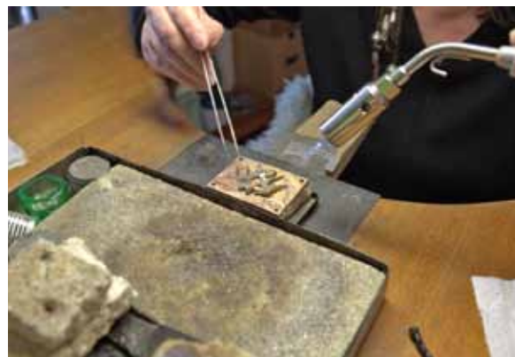
Das Dachdecker-Zunftzeichen für die Gürtelschnalle wird im Hartlötverfahren auf die Weltkarte gelötet
